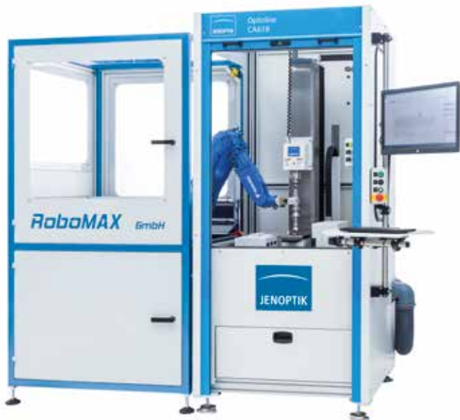
Beispielhafte Integration einer Opticline CA618 mit Roboter und Beladestation
