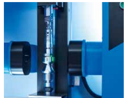
Einfaches Spannen des Werkstücks zwischen Spitzen
