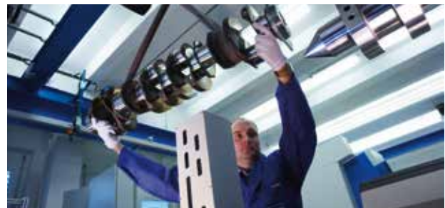
Einsatz in der Fertigung: Beladen einer Kurbelwelle bei der Werker selbstkontrolle
