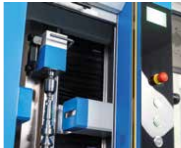
Integrierte Lichtschranke zum Schutz des Werkers gemäß internationaler Sicherheitsnormen
